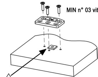
! Posizionare il dado prima di fissare il supporto / Place the nut before fasten the support / Positionner l'écrou avant de fixer le support
